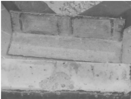
(b)主管内混凝土破坏情况
