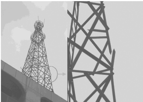
图 5 汶川地震某钢结构断裂
