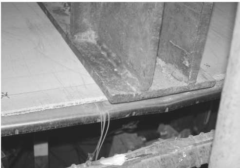
图 3 薄壁型钢试验破坏模式
