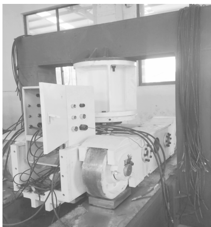
图 8 台车承载力与加载状态下的运行能力试验
