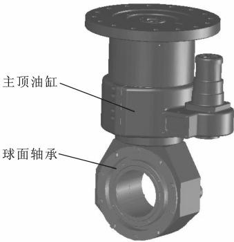
(b) 台车顶部油缸的构造
