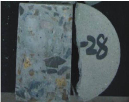
图 5 混凝土试件劈裂破坏面
