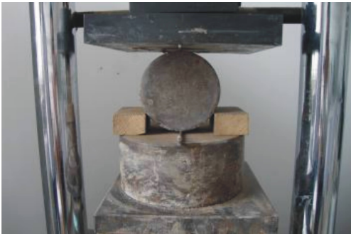
图 4 巴西圆盘试验试件固定方式
