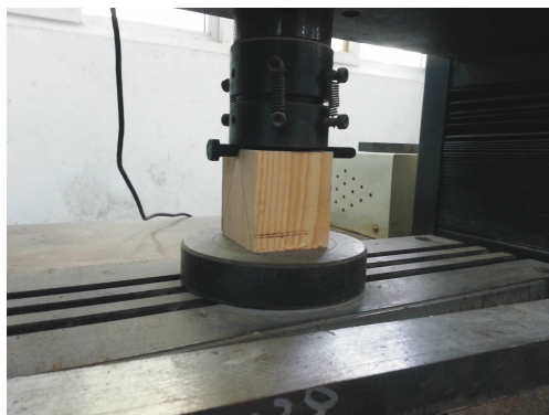
图 3 销槽承压试验装置
