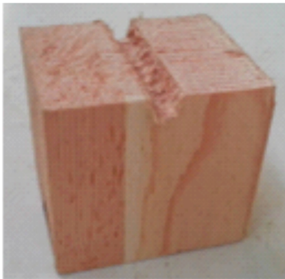
图 2 销槽承压试件
