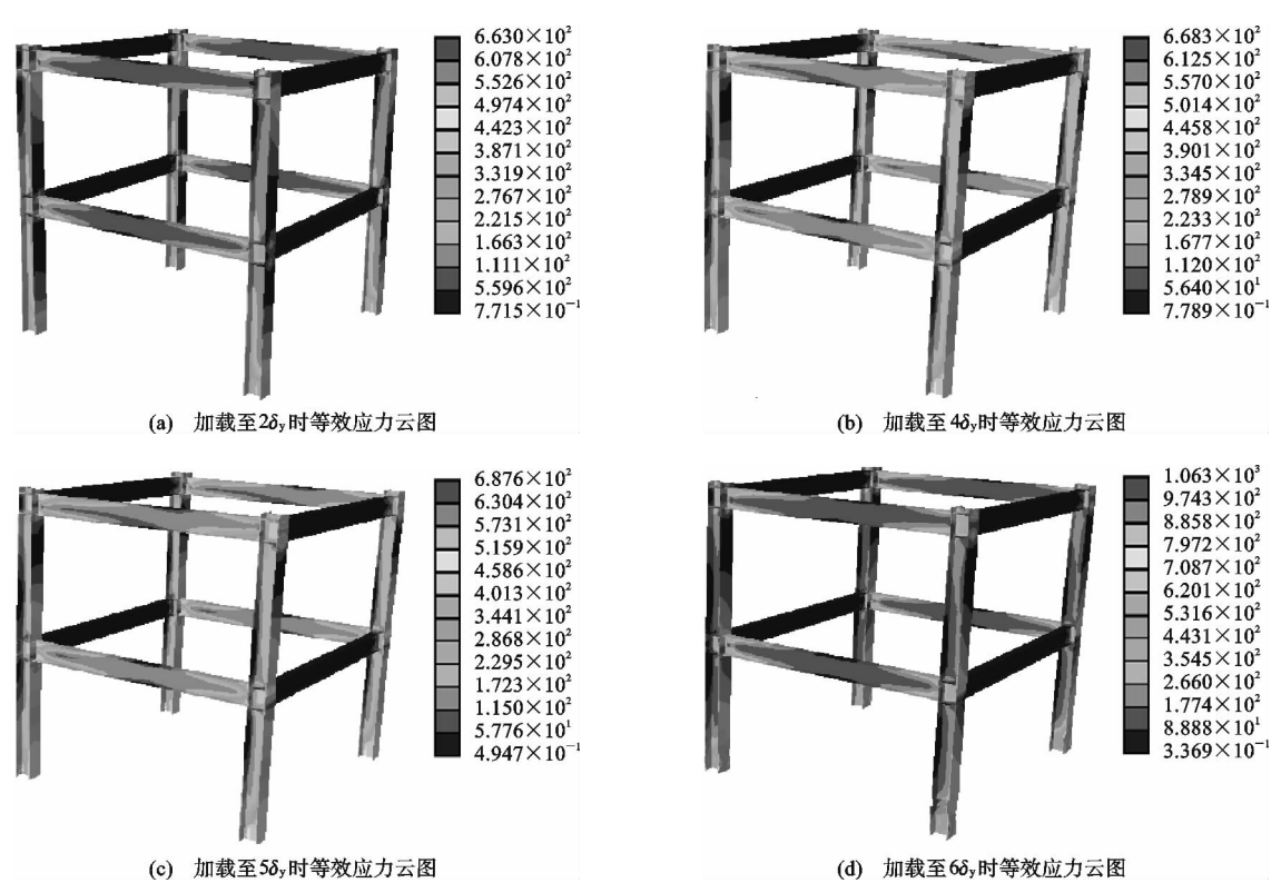
图 4 OSF 的应力发展 (单位:MPa)
