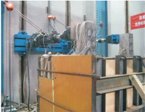
图 4 抗滑桩模型土箱及加载设备
