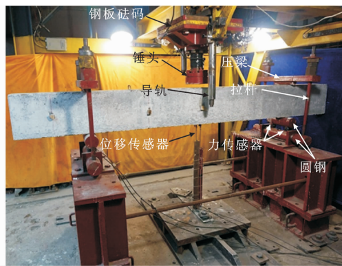
图 2 冲击试验装置
