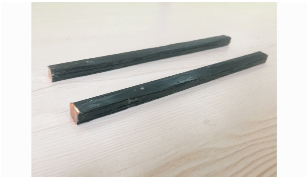
图 2 CFRP 传感元件 Fig. 2 CFRP Sensor Elements
