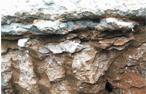
图 7 水泥浆液填充基础底部空隙效果图 Fig. 7 Effect Picture of Cement Slurry to Fill Gap at Bottom of Base
