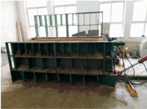
图 1 RBT 模式悬臂式挡土墙模型装置实体图 Fig. 1 Entity Diagram of RBT Model Cantilever Retaining Wall Model Device
