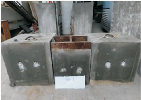
(c) 各焊钉破坏形态
