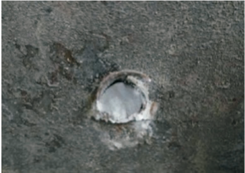
(a) 钢板面上的断痕
