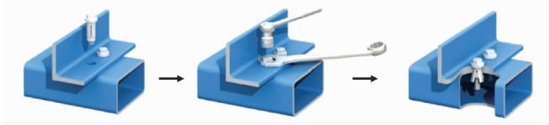
图 1 钢结构用自锁式单向螺栓安装示意
