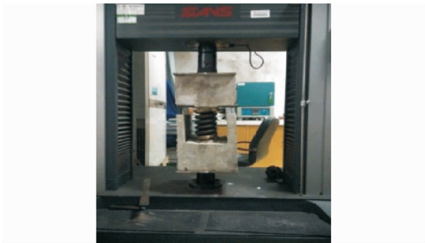
图 3 三维隔震墩竖向加载试验
