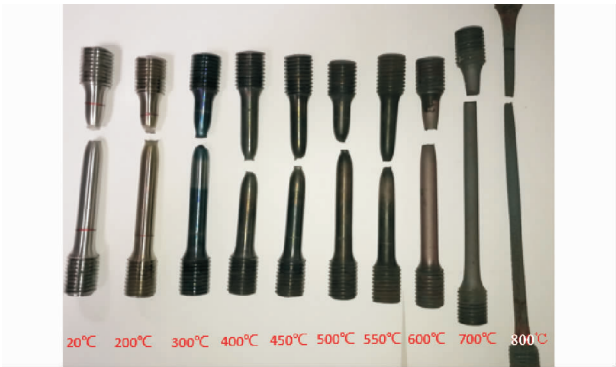
图 3 不同温度下 Q890 钢试件破坏状况
