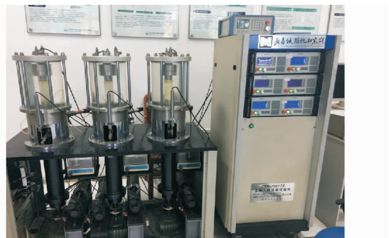
图1 CSS-2901TS土体三轴流变试验机
