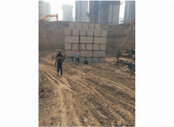
图 2 现场荷载试验 Fig. 2 Field Load Test
