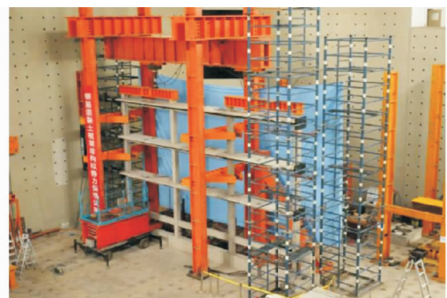
图 2 钢筋混凝土框架试验
