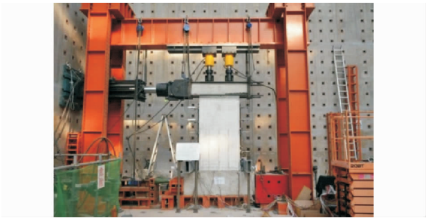
图 3 加载装置 Fig. 3 Loading Setup
