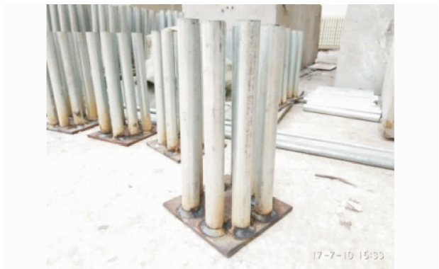
图 2 CFRP 筋锚固装置
