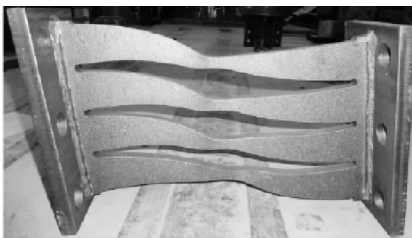
图 14 抛物线型阻尼器
