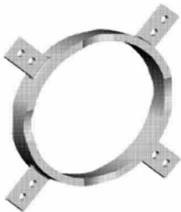
图 9 圆弧式削弱圆环阻尼器
