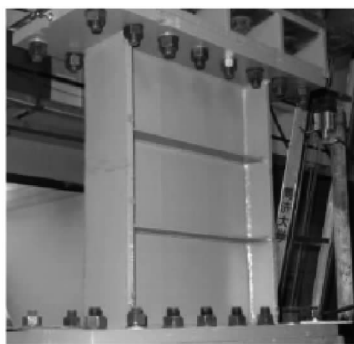
图 6 剪切钢板阻尼器
