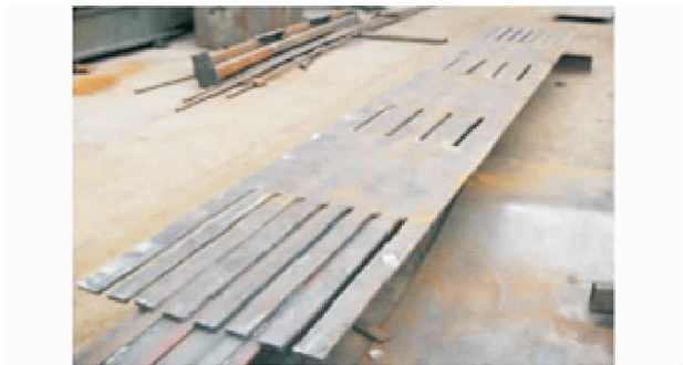
图 4 连梁阻尼器
