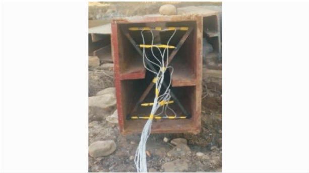
图 4 混凝土测点及钢筋骨架照片
