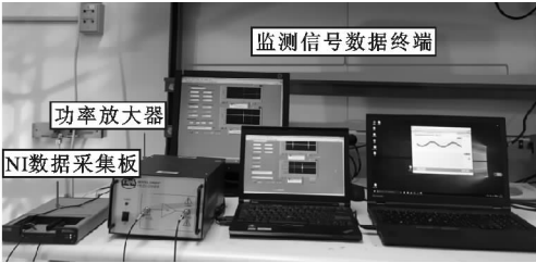
图 4 落锤冲击试验数据采集系统
