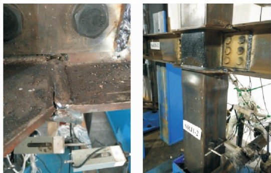
(a) 南梁下翼缘焊缝处母材开裂 (b) 柱端鼓曲
