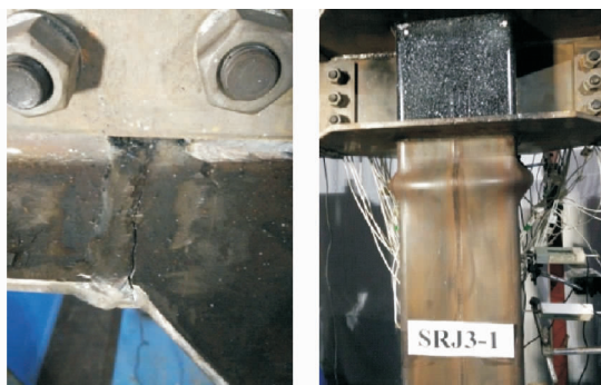
(a) 北梁下端焊缝母材出现裂缝 (b) 柱端鼓曲
