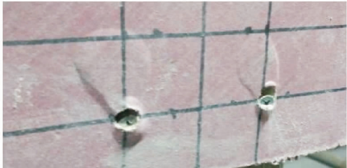
(b) 螺钉边距为20 mm和25 mm
