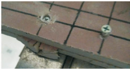
(a) 内侧板先于外侧板破坏
