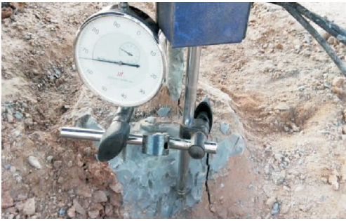
图 6 微型锚杆复合桩竖向抗拔试桩破坏现场
