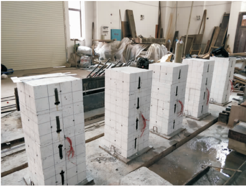
图 3 免模短柱与现浇短柱
