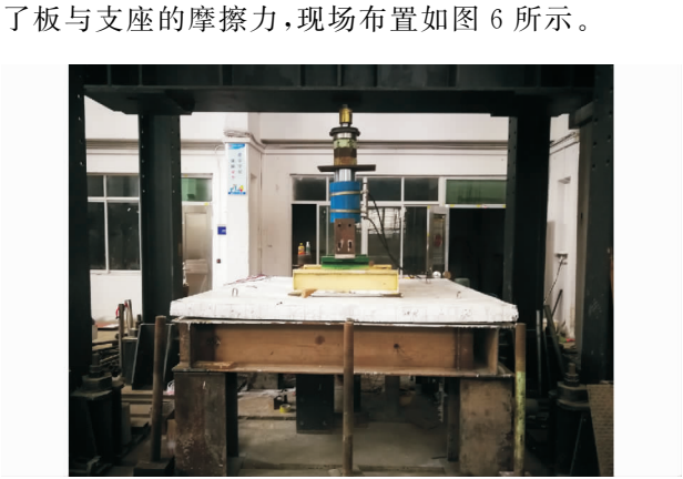
图 6 加载装置 Fig. 6 Loading Setup
