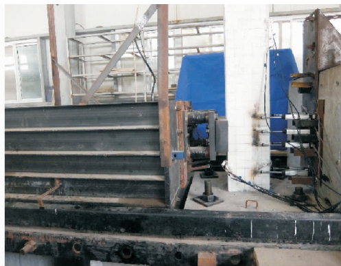
图 1 RC 桥墩撞击试验
