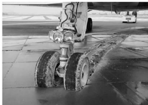
图 8 EMAS 使机轮制动
