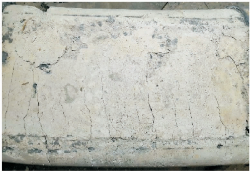
(b) 核心混凝土破坏形态
