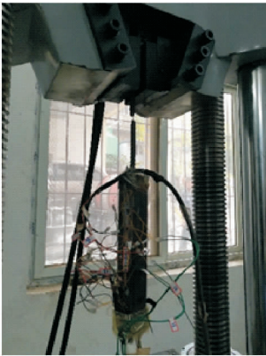
图 3 试验加载装置
