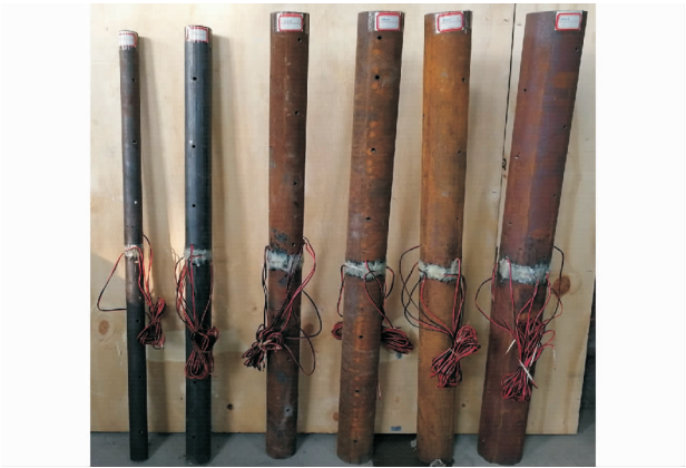
图 2 试验钢管及其注浆布孔形式 Fig. 2 Steel Pipe of Test and Layout of Hole for Grouting 液压千斤顶进行三分点加载(图 4),试验监测桩体跨中位置挠度,并在桩体两端安装位移计监测位移变化。另外,为了研究桩体应变,在桩体跨中截面处钢管外表面均匀粘贴 4 个纵向应变片和 4 个环向应变片,桩体外包浆上、下表面粘贴 2 对应变片,以监测外包浆体纵向和环向应变变化。
