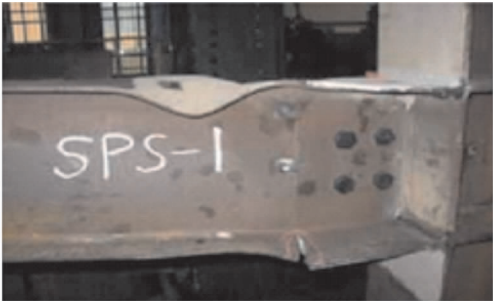
(a) 现场试件破坏形态
