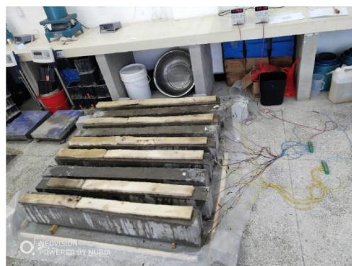
图 4 再生骨料混凝土梁通电锈蚀现场
