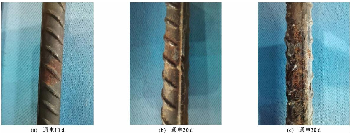
图 11 不同通电时长的钢筋锈蚀形态
