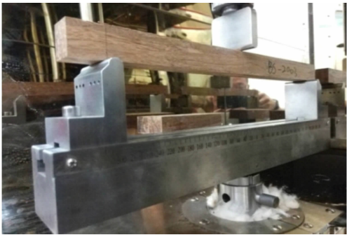
图 4 弯曲蠕变试验 Fig. 4 Bending Creep Test
