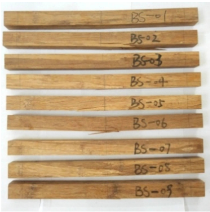
图 2 重组竹短期抗弯试件破坏模式 Fig. 2 Failure Mode of Short-term Bending Specimens of Bamboo Scrimber
