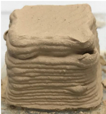
图 9 部分堆叠的打印试件 Fig. 9 Partially Stacked Printed Specimens
