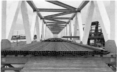
图 4 荷载试验
