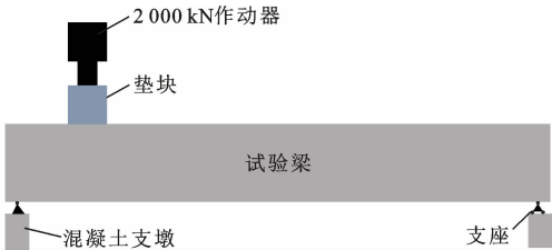
图 6 加载装置
