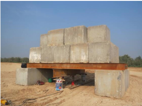
图 2 承载力试验 Fig. 2 Bearing Capacity Test
