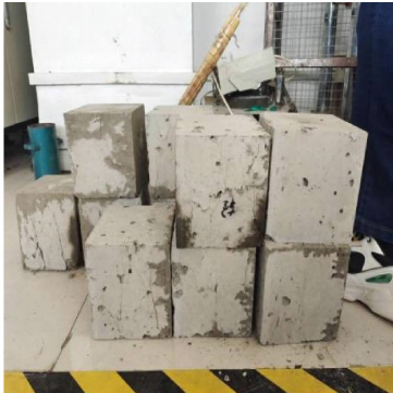
(c) 混凝土破坏形态
