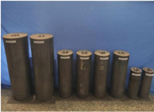
(b) 混凝土养护完毕
