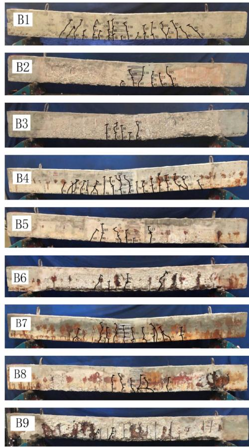
图 7 梁破坏时裂缝分布
