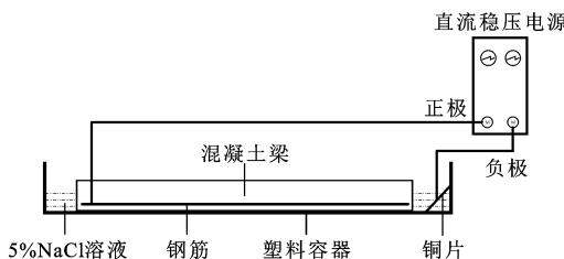
图3 加速锈蚀装置
