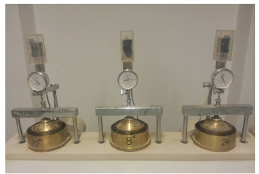
(b) 室内侧限压缩试验
