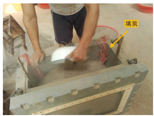
图 4 模型土填筑
