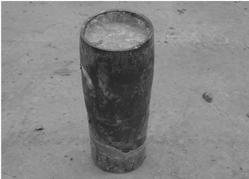
图 4 芯钢管混凝土柱的变形
