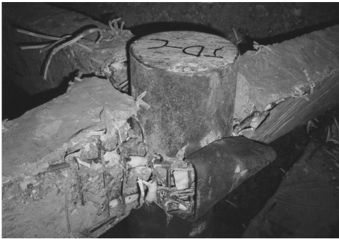
图 2 试件 JD-C 破坏形态
