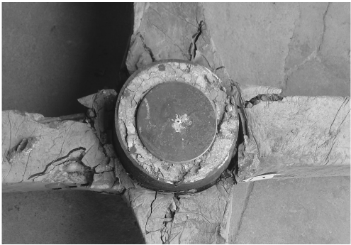
图 5 中节点破坏形态
