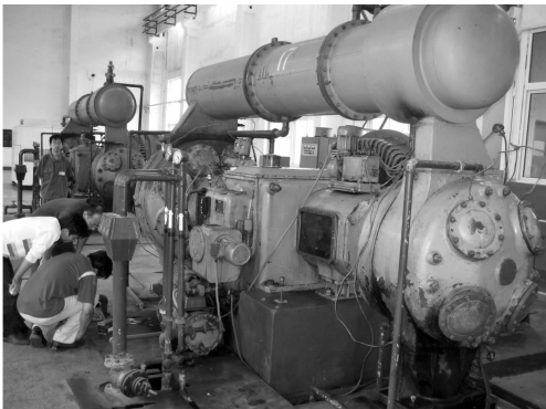
图 1 活塞式空压机 Fig. 1 Piston-type Air Compressor
