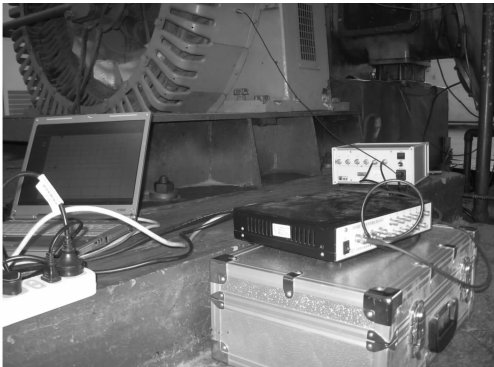
图 5 DASP 现场振动测试系统 Fig. 5 Vibration Test System of DASP on Site
