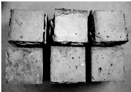
图 1 受压破坏的试件
