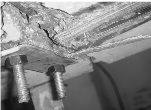
图 6 FRP 加固梁的破坏形态
