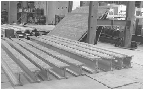
图 3 冷弯薄壁型钢-竹胶板组合梁
