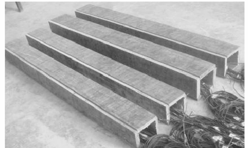
图 4 冷弯薄壁 C 型钢-竹胶板组合柱
