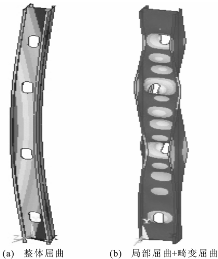
图 5 拼合截面柱的屈曲模态 Fig. 5 Bucking Modes of Build-up Columns
