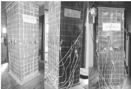
图 2 PBL 加劲型试件破坏形式
